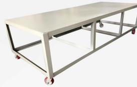
**Mesa de Trabajo** fabricada en lámina negra cal. 18 y ángulo de 2" x 5/16" con o sin rodajas de uso rudo, acabado en pintura electrostática horneada. Medida de 300 cms de largo x 100 cms fondo x 75 cms de altura.
