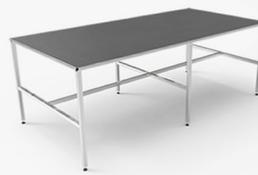
**Mesa de Trabajo** fabricada en perfil de acero de 1 x 1" y 2 x 2", cubierta fabricada en madera, acabado en pintura electrostática horneada. Medida de 240 cms de largo x 120 cms fondo x 75 cms de altura.
