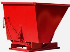
**Tolva Autovaciable de acero** fabricado en placa de acero, ángulo de 2" y PTR, calibres de acuerdo a capacidad de carga, acabado en pintura electrostática horneada. Medidas de acuerdo a necesidad del cliente.
