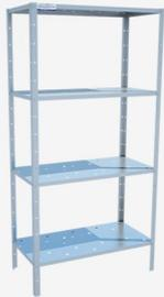
**Anaqueles Metálicos** con entrepaños fabricados en lámina cal. 22 y 24, postes metálicos cal.14 acabado en pintura electrostática horneada. Medida de 180 cms de alto x 85 cms frente x 40 cms de fondo.
